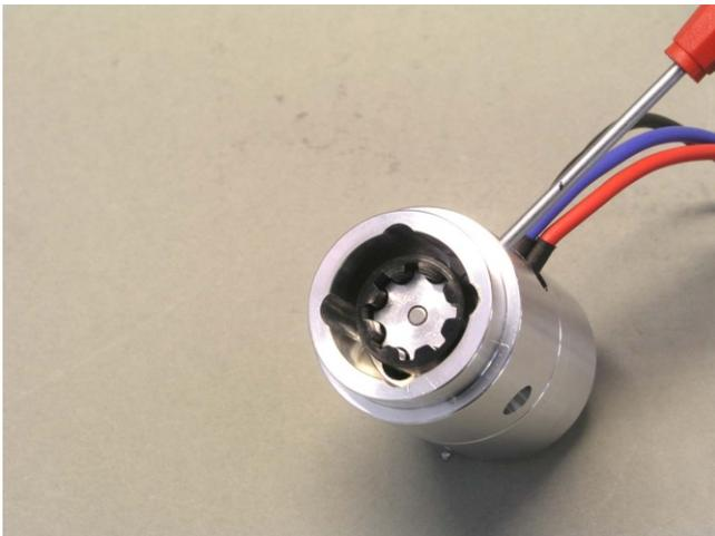
Diese Pumpenkupplung wird auf der Motorwelle des Brushless-Motors montiert .
