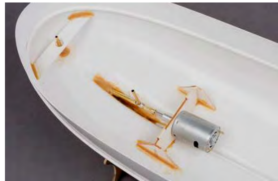
Abb. Antrieb im Rumpf verklebt
