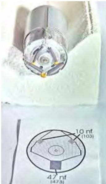
Abb. Motor entstören
