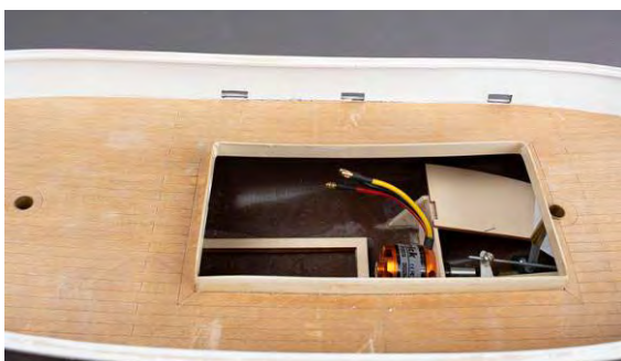
Vue: dalots réalisés, avec le pont en place
