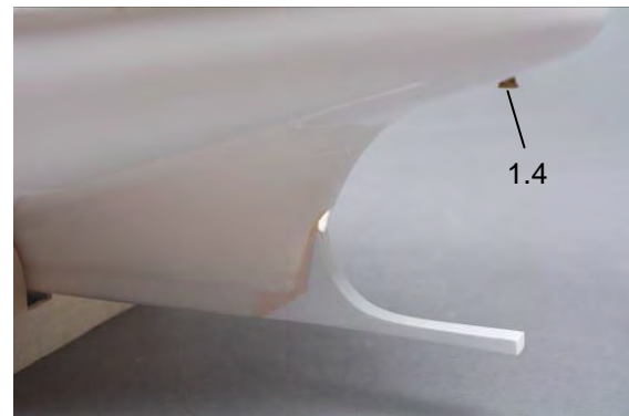
Fig. rudder heel filled
