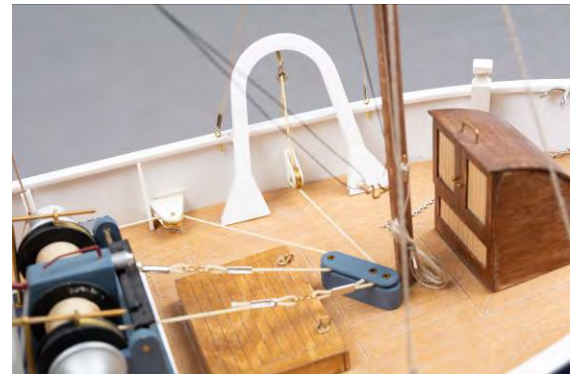
Vue: portique à filet et poulies de renvoi
