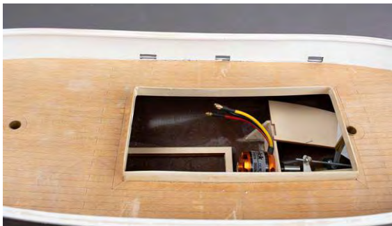
Abb. Speigaten hergestellt und Deck platziert
