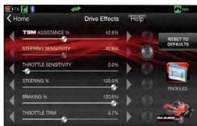
Tippen und Schieben Sie um TSM, Lenkungsempfindlichkeit, Gaseinstellung, Bremskraftverteilung und mehr einzustellen!
